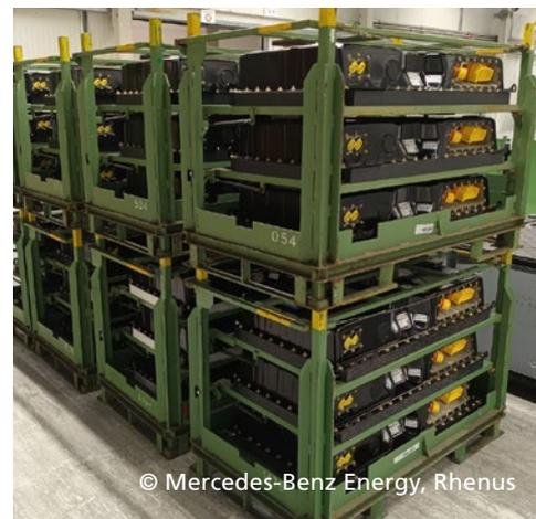
Abbildung 21: Bodenblocklagerung von Batterien
