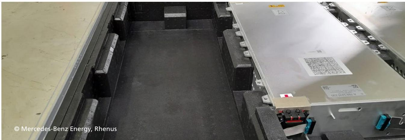
Abbildung 15: Vereinzelung von Batteriemodulen in Transportboxen
