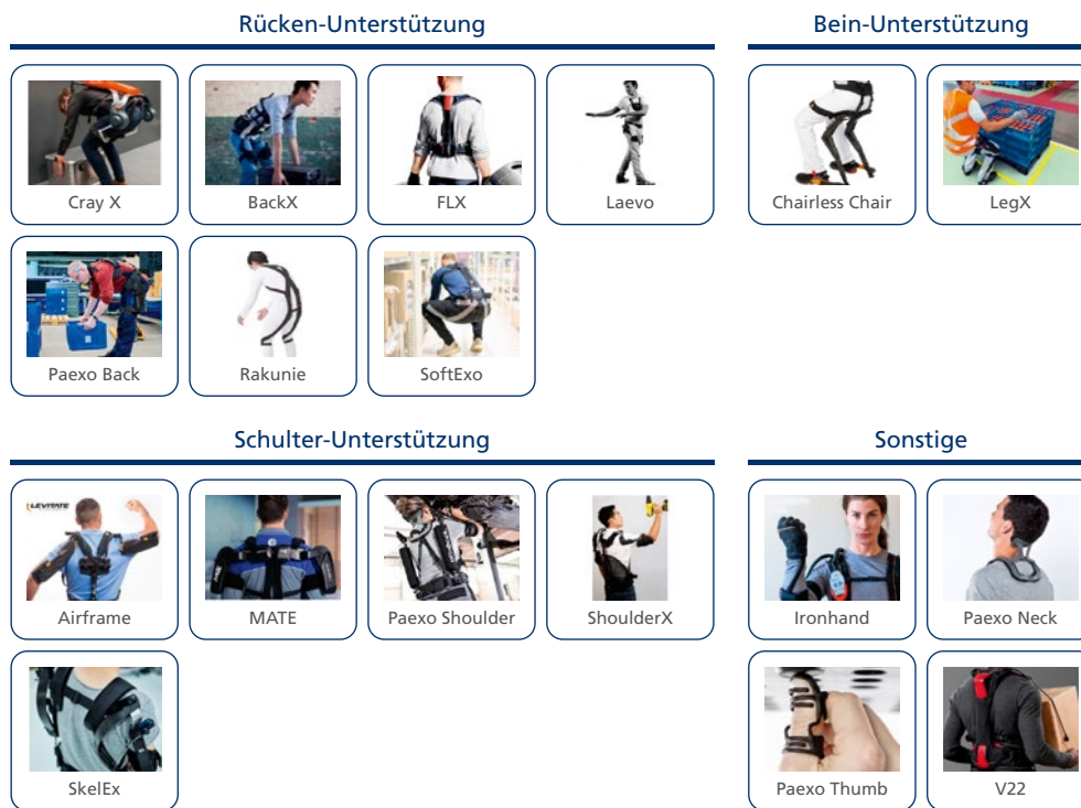
Abbildung 5: Auf dem deutschen Markt verfügbare Exoskelette (Stand: November 2020) (Quelle: Fraunhofer IML, eigene Darstellung)
