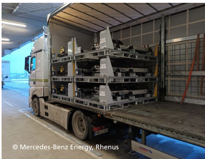
Abbildung 20: Beispiel zur Verladung von Lithium-Ionen-Batterien in den Lkw
