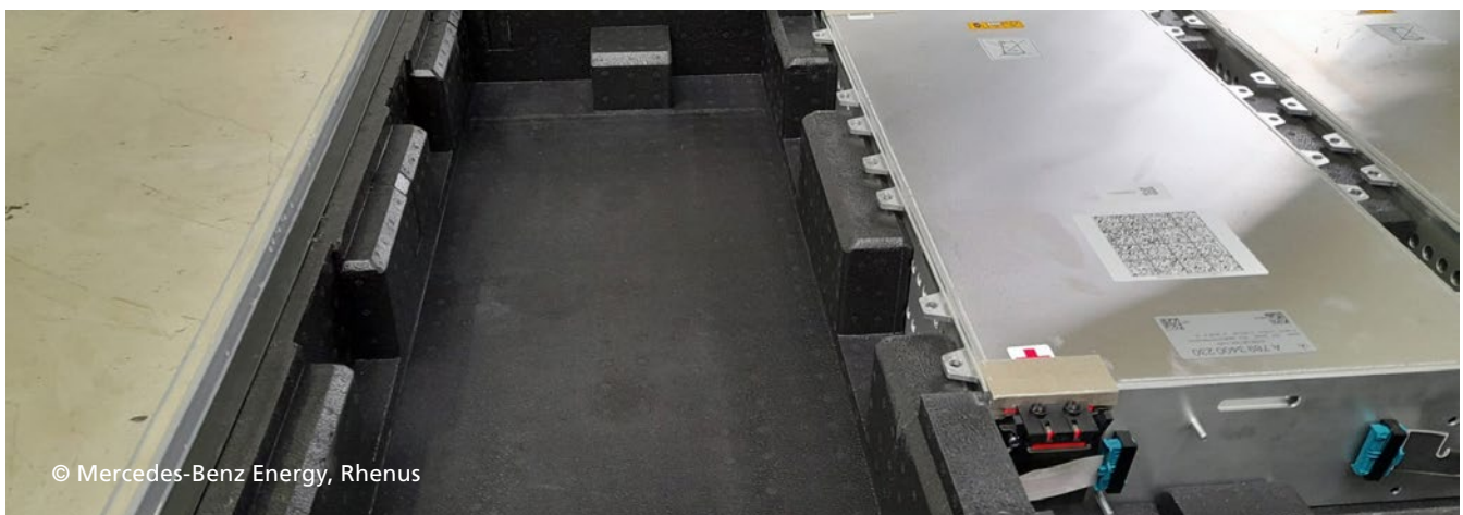
Abbildung 15: Vereinzelung von Batteriemodulen in Transportboxen
