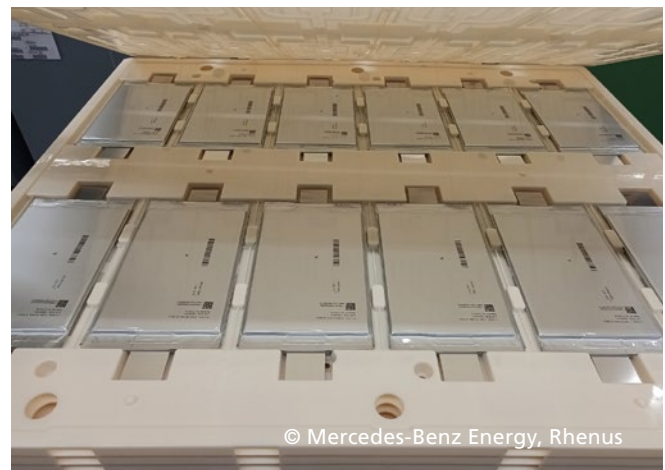
Abbildung 14: Vereinzelung von Batteriezellen in Transportboxen
