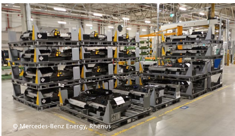
Abbildung 21: Bodenblocklagerung von Batterien
