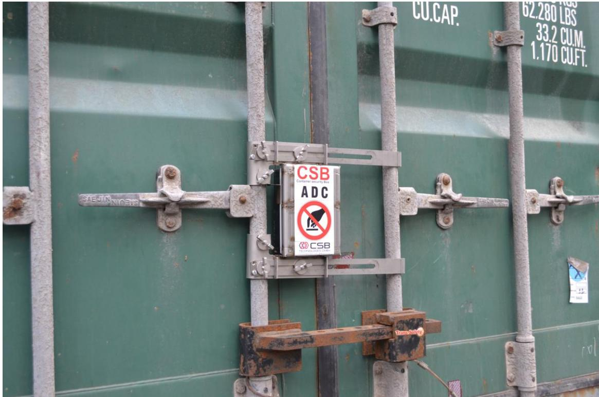
Abbildung 13: Container Security Device (CSD) am Container (Quelle und © Fraunhofer IML)
