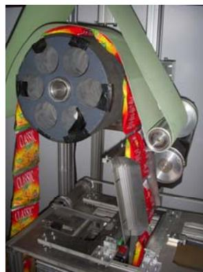
»Das Beutelkommissioniersystem ermöglicht das automatische Kommissionieren gefüllter Kunststoff- und Verbundfolie-Beutel.«
