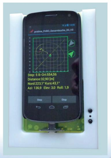
Mit zusätzlicher Hardware und der LawinenFon-App wird jedes Smartphone zum Lawinensuchgerät. Im Bild: der Prototyp des Galileo-LawinenFon.
