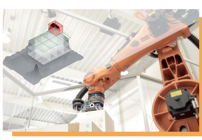
ne Grundlagenforschung auf diesem Gebiet bilden einen innovativen Beitrag des Projektes. Einen anderen bildet ein neu entwickeltes algorithmisches Verfahren zur Beladungserkennung mithilfe dieser Technologie. Es verwendet zuvor generierte Informationen über die Lage, Größe und Orientierung der Packstücke, die die Verschlankung der Auswerteeinheit ermöglichen.
