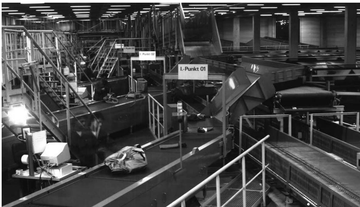
Packstückidentifikation und Einleitung in die Sortieranlage am halbautomatischen Identifikationspunkt im Airmail-Center Frankfurt. Das neue IT-System steuert die gesamte Anlage.
