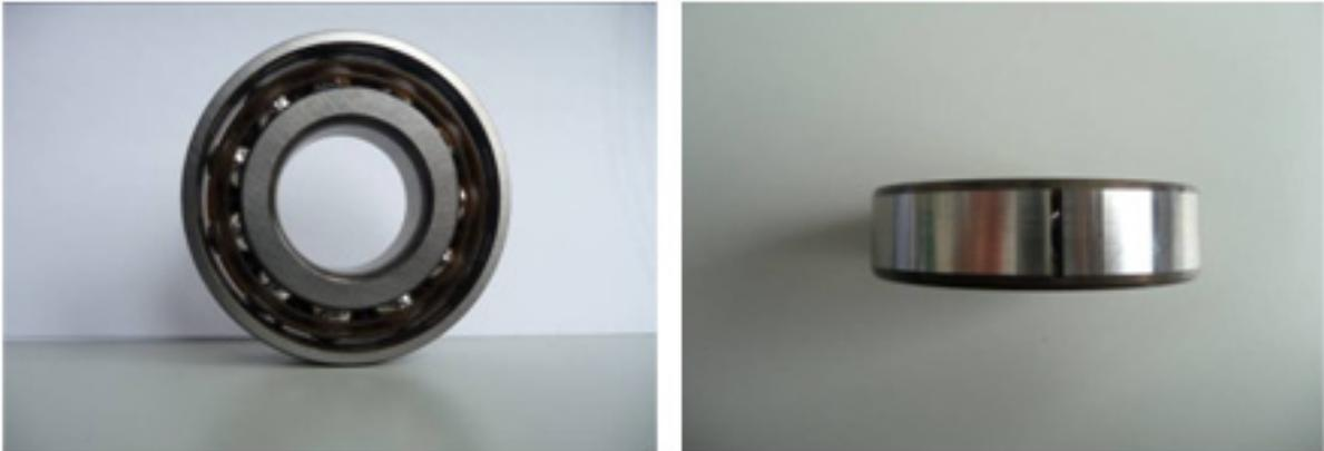
**Abb. 79: Vorgeschädigtes Lager**
