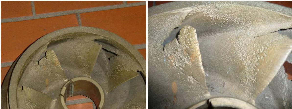
**Abb. 34: Durch Kavitationserosion geschädigtes Laufrad, Lehrstuhl SAM, TU Kaiserslautern [Quelle: SAM]**
