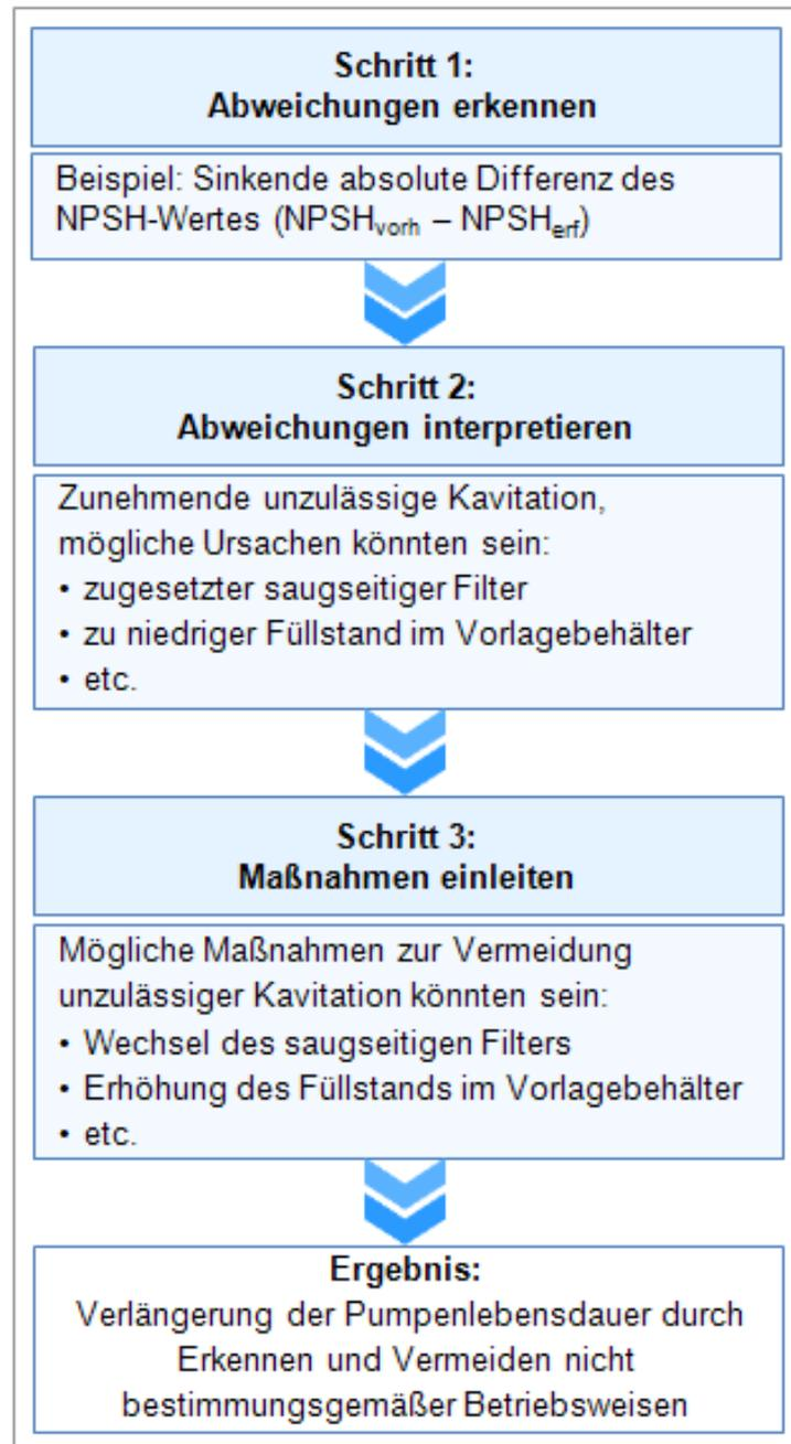
**Abb. 110: Potenzial des Verfahrens zur Pumpenüberwachung und Zustandsdiagnose zur Verlängerung der Pumpenlebensdauer**
