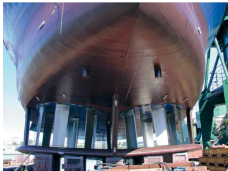
1 Voith-Schneider-Propeller und Drehkreismanöver eines mit VSP ausgerüsteten Hafenschleppers
