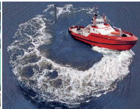
1 Voith-Schneider-Propeller und Drehkreismanöver eines mit VSP ausgerüsteten Hafenschleppers
