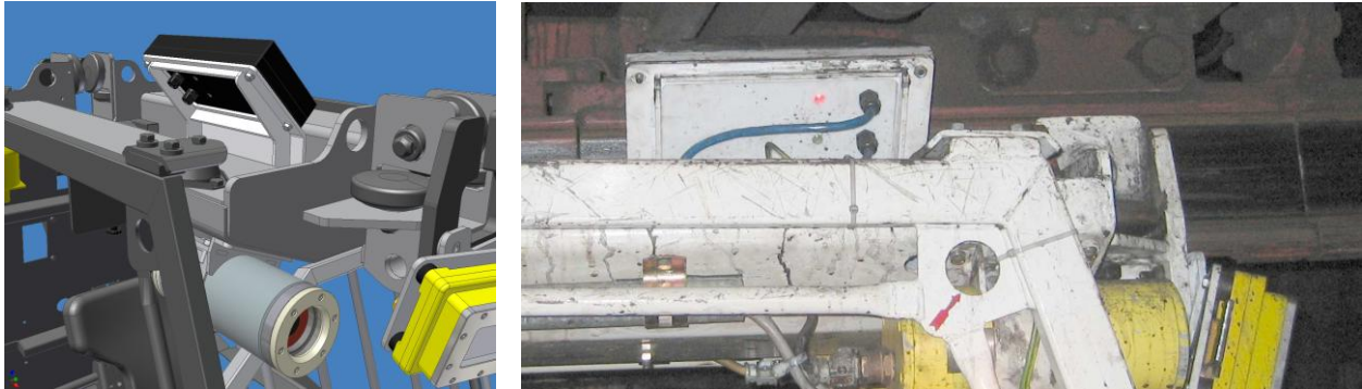
Abb. 6: Anordnung des RFID-Lesegeräts auf der Fahrerkabine der Dieselkatze
