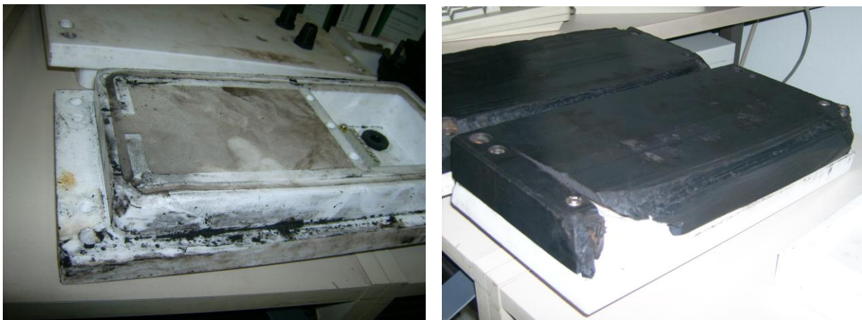
Abb. 7: RFID-Lesegerät nach dem Einsatz unter Tage
