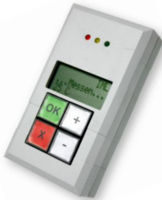
Geräteeinheit des Drahtlosen Pick-to-Light Systems (Prototyp)
