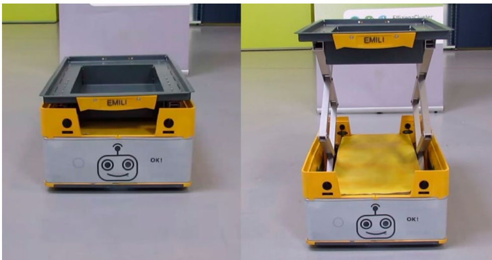
Abbildung 4: EMILI – Ergonomischer Mobiler Interaktiver Ladungsträger für die Intralogistik [18]
