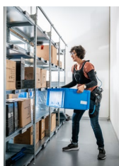
Abb. 5: Person mit dem passiven Exoskelett Lavo Flex (Bildquelle: Fraunhofer IML, Michael Neuhaus)
