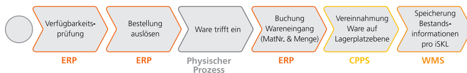
Abbildung 5 Exemplarischer Prozessablauf im Wareneingang unter Einbindung des CPPS
