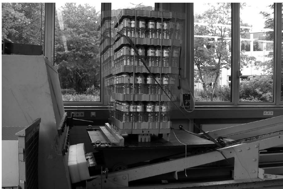
Simulating the docking of railway cars by impact tests. Aufpralltests, die das Ankoppeln von Waggons simulieren.
