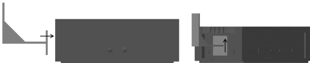
Bild 6: Ablauf bei der Aufnahme von Behältern mit dem passiven Greifer
