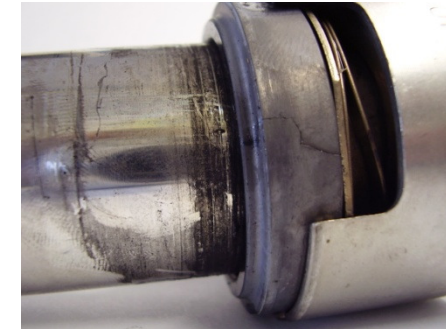
Gleitring mit Thermospannungsschaden
