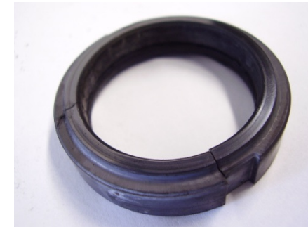
Gleitring mit Thermospannungsschaden
