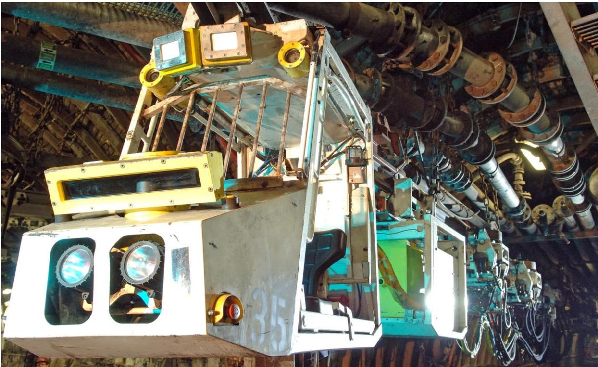
**Abb. 1: Automatisierte Dieselkatze im Einsatz auf Bergwerk Ost**
