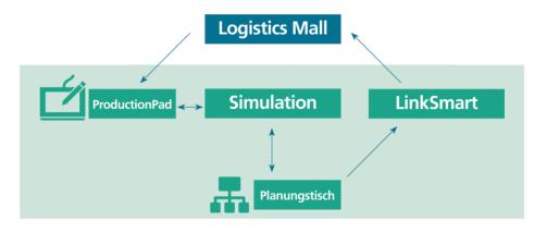
An einem Planungstisch wird die Produktionsumgebung dieses Szenarios nachgebildet. Die Middleware-Software »LinkSmart« überträgt Ereignisse direkt von den Produktionsmaschinen an das LAS. Über die Software-Plattform »Logistics Mall« erfolgt die cloudbasierte Datenbereitstellung.
